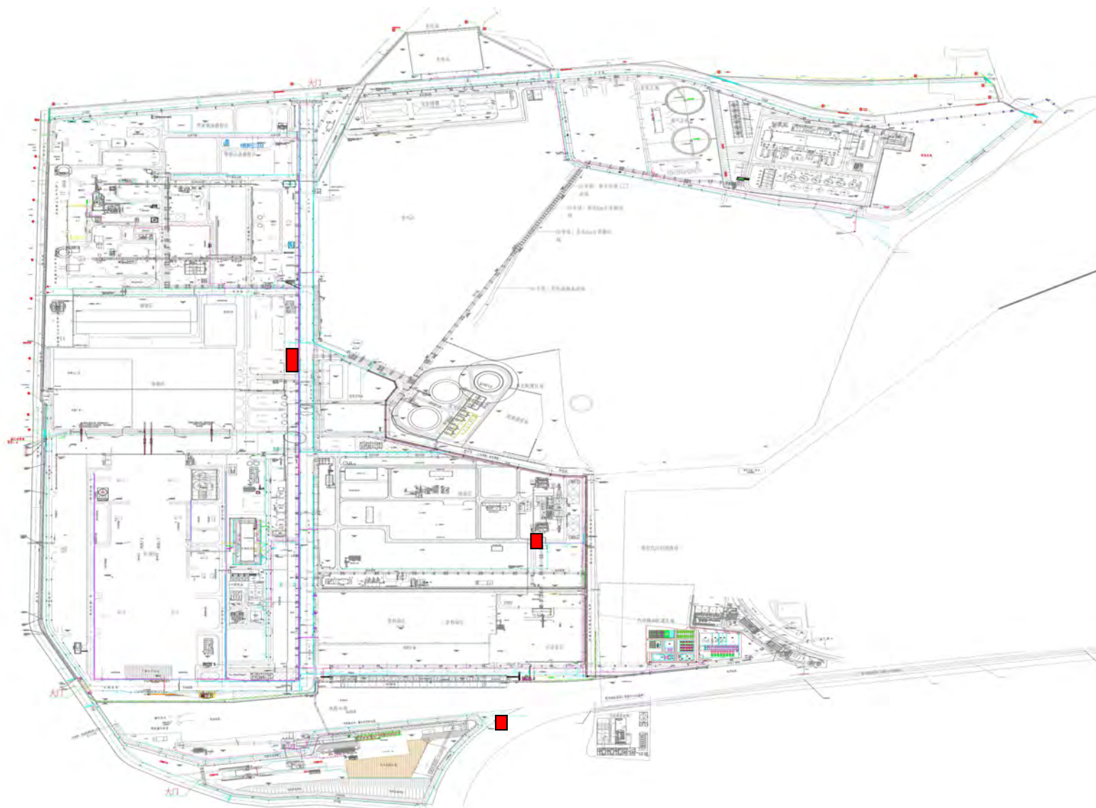
图 4.2-5 污水及事故水导排系统示意图
