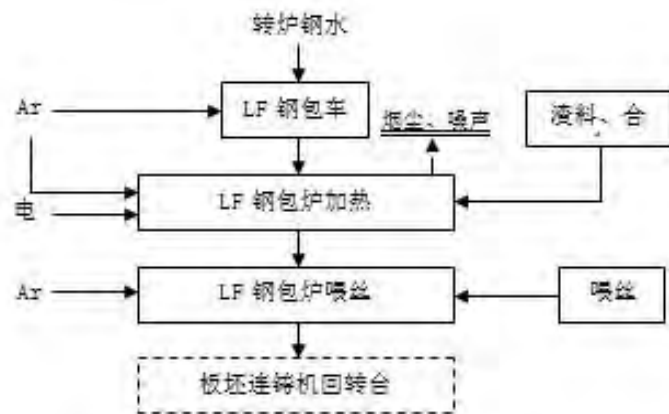
图 3.5-6 LF 钢包精炼炉生产工艺流程及产污环节示意图
