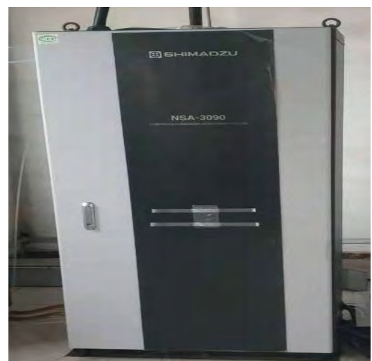
5#烧结脱硫在线监测设备
