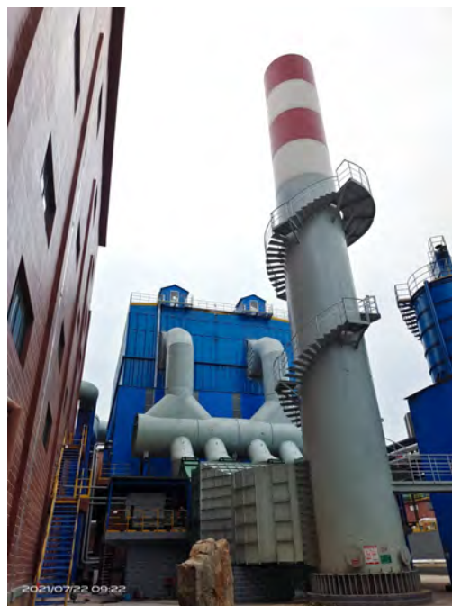
Q030 5#高炉矿槽除尘排放口
