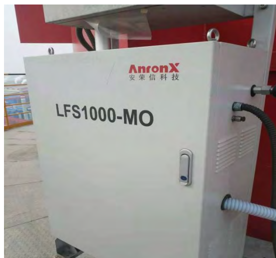
5#烧结脱硫在线监测设备
