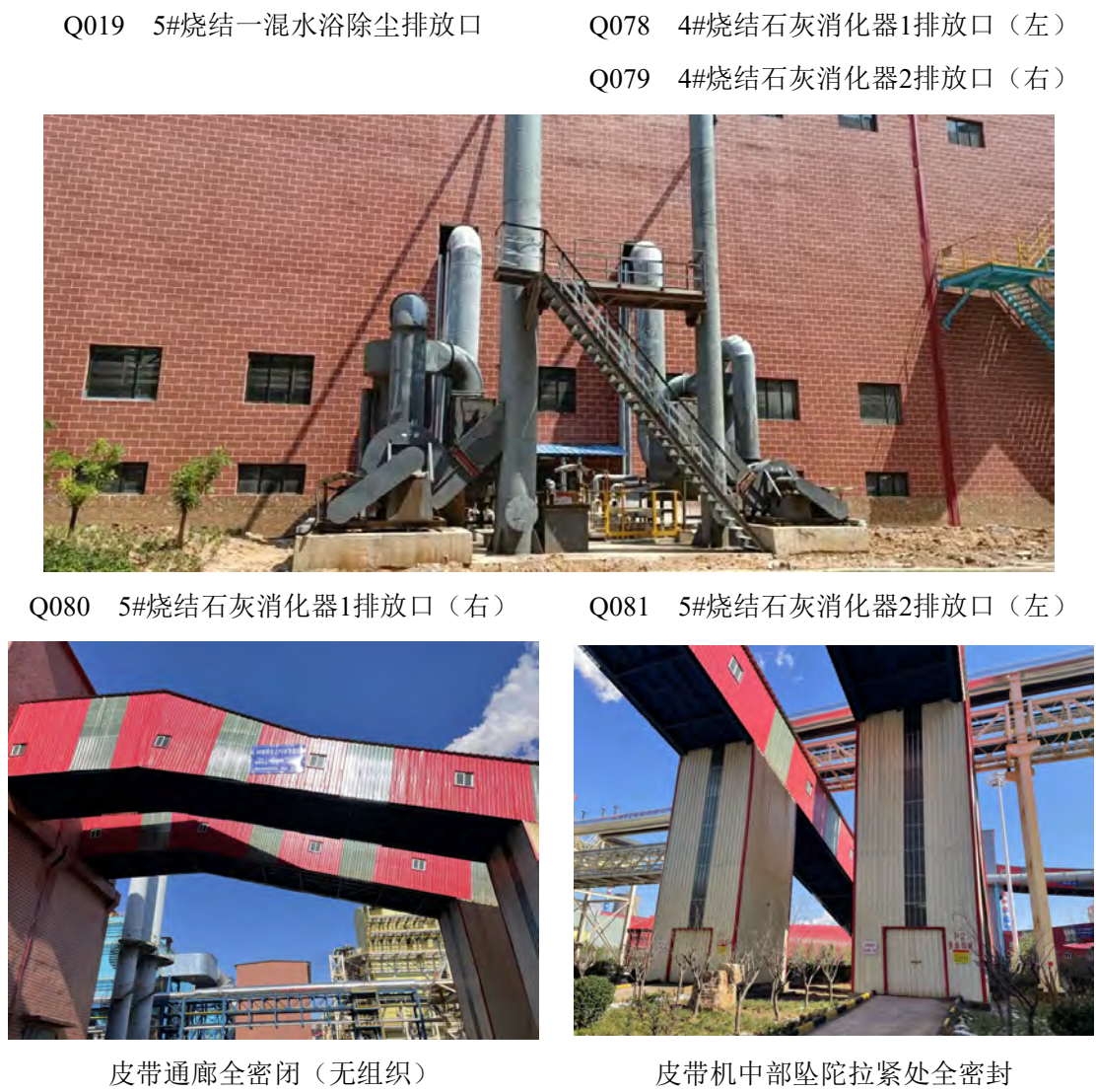
图 4.1-2 烧结系统废气处理措施及排气筒设置情况照片
